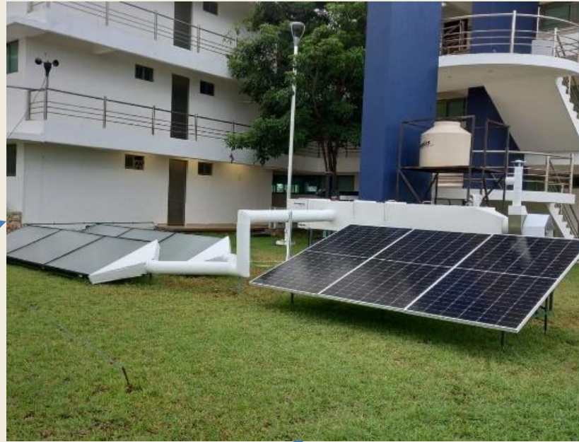
Ilustración 1: Secador solar con hibridación de tecnologías solares
