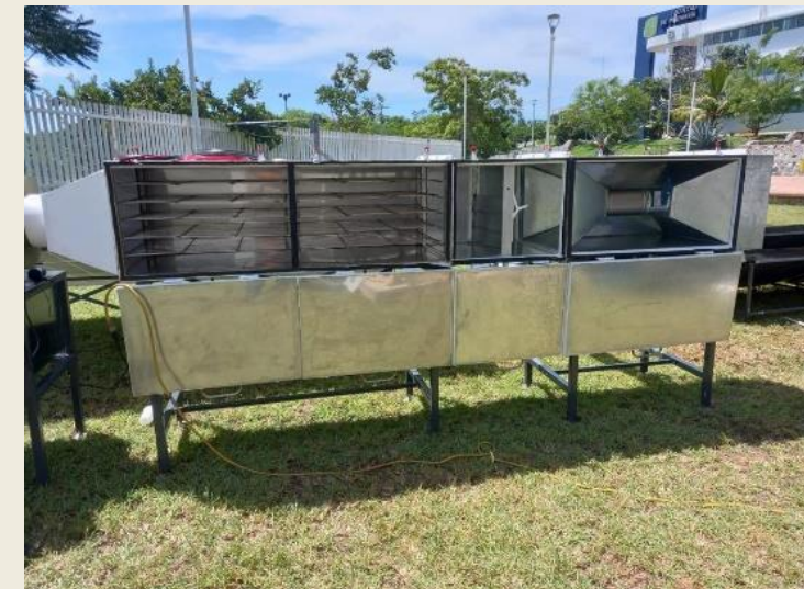
Ilustración 2: Secador solar tipo túnel.
